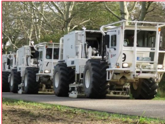
Figuur 5: een voorbeeld van de trilwagens in actie.
